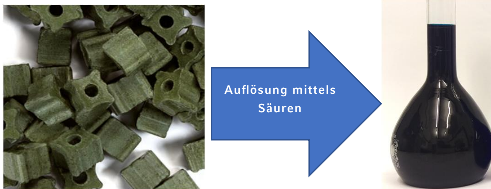
Abbildung 7: Auflösung des V-P-haltigen Katalysators mittels Schwefelsäure oder Oxalsäure. Bilderquellen: Links: https://www.clariant.com/de/Solutions/Products/2019/04/15/08/29/SynDane-Series . Rechts: Masterarbeit Natalie Weichselgartner 2020.
