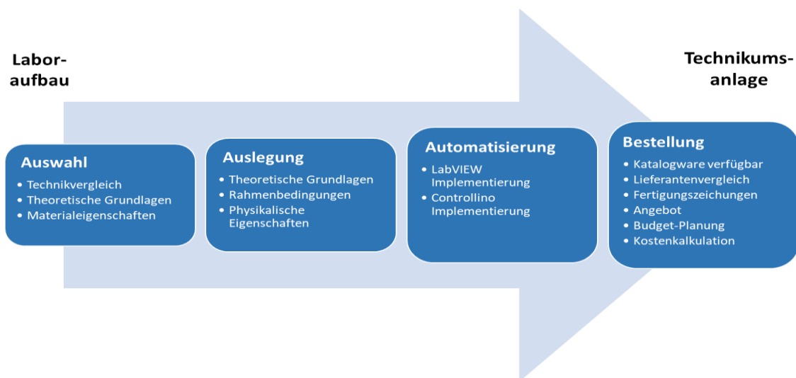
Abbildung 1: Planungsphase der pTA: Vom Laboraufbau zur portablen Technikumsanlage.
