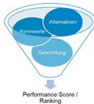
Abbildung 2: In DIMOP wird das multikriterielle Bewertungsverfahren TOPSIS verwendet, um basierend auf individuellen Präferenzen des Nutzers (Gewichtung) aus den verschiedenen Kennwerten zu technischen, ökologischen und ökonomischen Größen ein Ranking der Produktdesigns (Alternativen) zu ermitteln.
