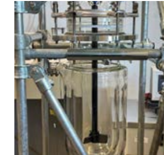
Abbildung 2: Rührkesselreaktor der SE-Elutionsanlage mit einem Volumen von 5 Litern
