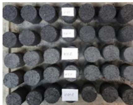
Abbildung 2: Übersicht über verschiedene Testreihen im Rahmen der Versuche zur Beimischung von Gießereistauben zu Siliziumkarbid-Formlingen
