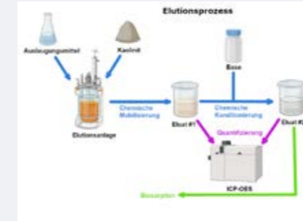
Abbildung 1: Schematischer Aufbau des semi-kontinuierlichen Elutionsprozesses
