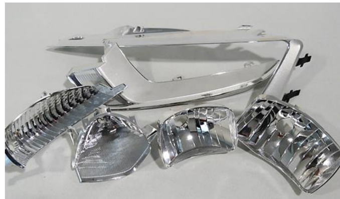
Abbildung 12: Mischabfall aus der Produktion von Scheinwerfern (links), aluminiumbeschichtete Kunststoffe (rechts)
