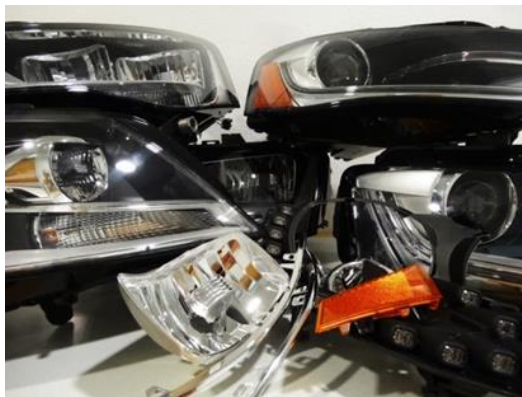
Abbildung 12: Mischabfall aus der Produktion von Scheinwerfern (links), aluminiumbeschichtete Kunststoffe (rechts)
