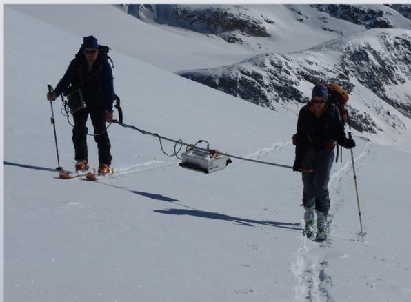
Typische Messverfahren zur Untersuchung von kleinen Gletschern wie in den Bayerischen Alpen: Vermessung der Gletscheroberfläche mit einem Tachymeter (links), Bestimmung der Oberflächenhöhe mit einem Laserscanner (mitte), Messung der Eisdicke mit einem Bodenradar (rechts) auf Skiern.
